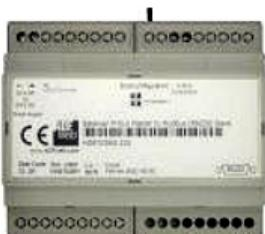
Gateway (konverter) iz M-Bus na Modbus. Modbus RS485 izlaz. Opremljen galvanskom izolacijom između M-Bus i RS485.
