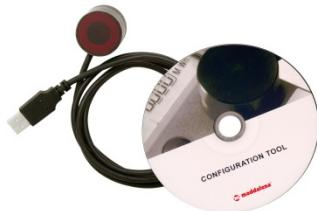
Set za konfiguraciju i očitavanje, optička glava za M-Bus ili Wireless M-Bus uređaje: microCLIMA brojila termalne energije, Gradus alokatori i FAW kompaktni radio modul. Omogućava očitavanje podataka (.csv) s kalkulatora na računalu i postavku parametara, kao npr. početni podaci , automatsko očitavanje, M-Bus adresu, ulazni impulsi.
