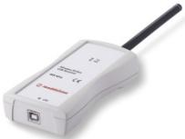
Jednostavan Wireless M-Bus 868 MHz radio prijemnik za mobilno „walk-by“ (bežično daljinsko očitavanje podataka) sustav očitanja, dizajniran za spajanje preko USB-a na prijenosno računalo. Podaci se prikupljaju i prenose preko serijskog ulaza na računalo opremljeno Maddalena softverom za očitavanje. Napajanje preko USB-a. Podržani modusi: S1 i T1. Upravljanje neograničenim brojem brojila.
