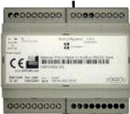
Gateway (konverter) iz M-Bus na Modbus. Modbus RS232 izlaz. Opremljen galvanskom izolacijom između M-Bus i RS232.
