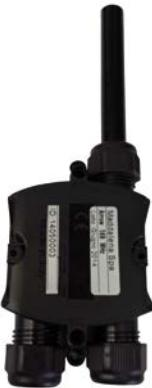
ARROW 169 radio primopredajnik koji bilježi očitanje uređaja / brojila zajedno s njim i onda ga prenosi putem bežične M-Bus Radio veze 169 MHz (N1 načinu rada). Može spojiti na bilo koju vrstu brojila koje ima pulsni izlaz (mogućnost priključenja za različite vrste medija: voda, plin, struja ...). Baterije (zamjenjive).Vijek trajanje baterije: do 10 godina (u AMR set-up-u načunu rada).
